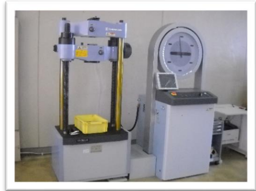
材料試験：材料を引っ張り、材料の強さを調べる試験も行います。
