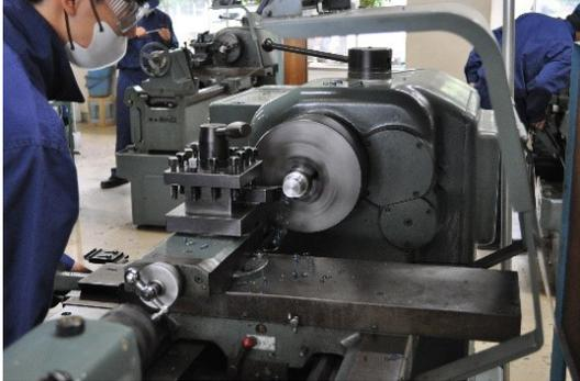
**旋盤実習:**材料を回転させ、刃物で0.001mm単位の精度で切削加工を行います。
